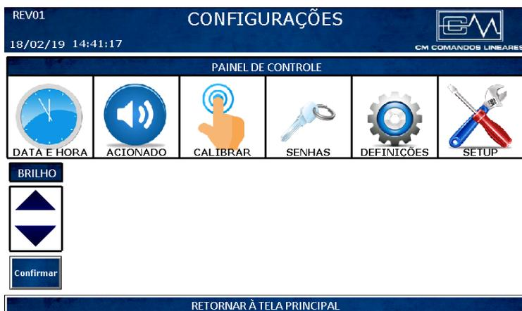
A IHM possui configurações de hora/data, temporização no alarme, calibração da tela para maior precisão no toque, alterar senhas e além de configurações para a nomenclatura de cada sala/sistema e para os sistemas com localizador de falhas também por leito/réguia.
