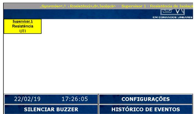
Quando ocorrer uma falha em algum ramo específico do circuito, o supervisor respectivo mudará o status de verde para amarelo, indicando em qual supervisor está a falha.
