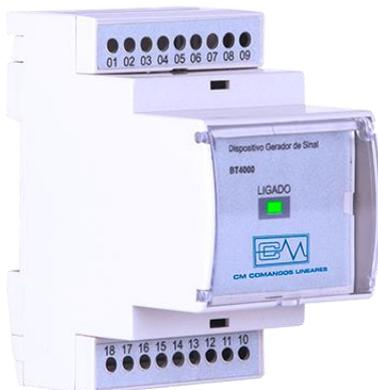
O dispositivo Gerador de sinais BT4000 é um dispositivo que tem por finalidade a localização de falhas de isolamento em um sistema de aterramento IT Médico e de acordo com as características exigidas pela norma IEC61557. O dispositivo, na verificação de uma falha de isolamento, injeta uma baixa corrente controlada inferior a 1mA. Tal sinal de corrente é suficiente para que seja detectada a falha de isolamento através do **Dispositivo Localizador de Falhas** conectado a esta rede de alimentação.
