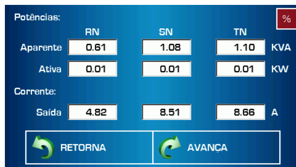
Tela de medições das potências de saída em kVA, kW e a corrente em (A).
