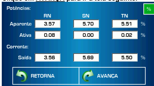
Tela de medições das potências de saída em percentual, basta clicar no botão % no canto superior da tela, mostra kVA%, kW% e A%
