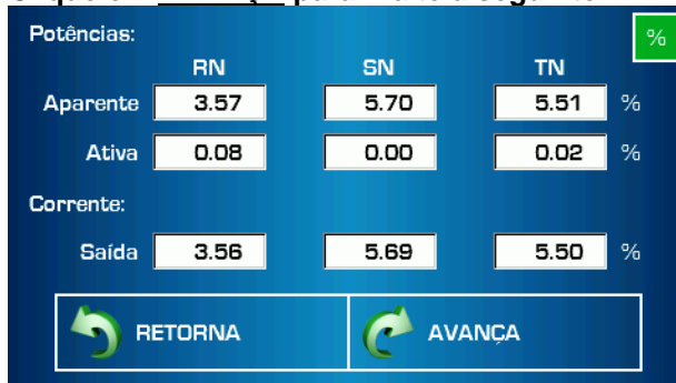
Tela de medições das potências de saída em percentual, basta clicar no botão % no canto superior da tela, mostra kVA%, kW% e A%
